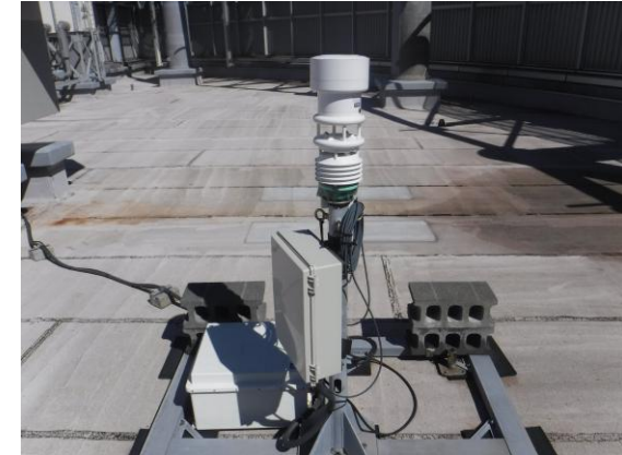
複合気象測器(WS601, Lufft社製)
